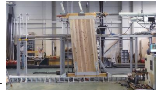
ログパネル構造試験のようす
